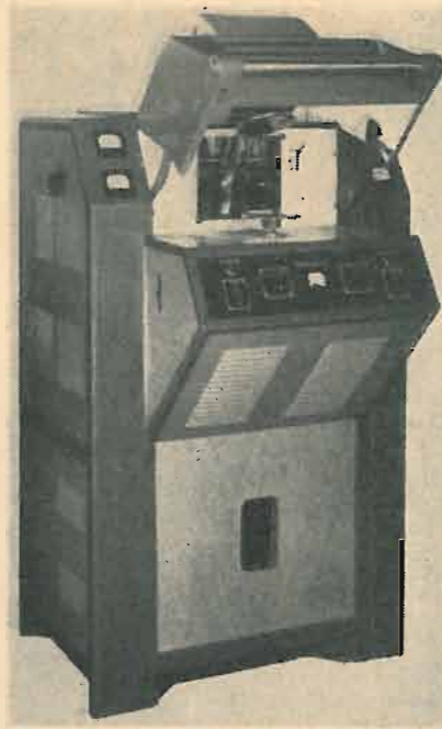
Forno ad AF per riscaldamento dielettrici. (Vista interna dell'utilizzatore).
